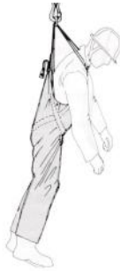
Bild 3: Rettungsgurt in Arbeitshose eingearbeitet
