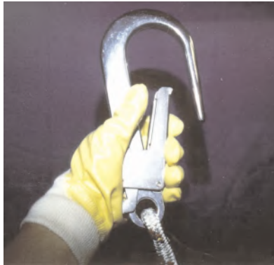
Bild 9: Karabinerhaken mit großer Öffnungsweite (Rohrhaken)
