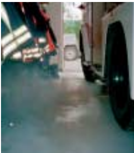
Gefahr ... Dieselmotor-Emission in der Fahrzeughalle
