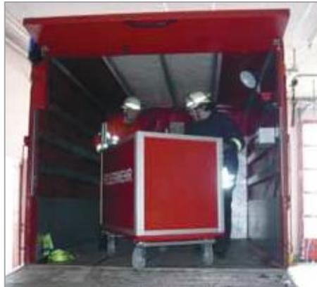
Das großflächige Auslegen der Matten auf der gesamten Ladefläche zum dauerhaften Verbleib ist nicht zu empfehlen. Durch stetige Verschmutzung der Oberfläche lässt der Wirkungsgrad der Rutschhemmung nach. Rutschhemmendes Material ist für eine ordnungsgemäße Ladungssicherung immer mit einem geeigneten Zurrmittel zu kombinieren.
