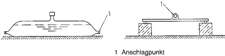
**Bild 25:** Beispiele für durch Eigengewicht gehaltene Anschlageinrichtungen
