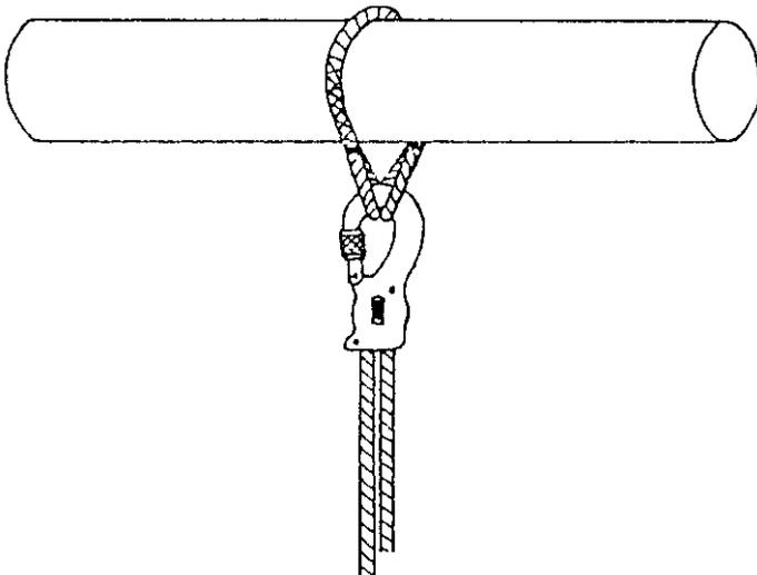
**Bild 26:** Richtiges Anschlagen: Zur Erhaltung der Funktionsfähigkeit des Falldämpfers wird ein Anschlagverbindungsmittel mit zwei Augen verwendet, welches über ein waagerechtes Tragelement gelegt wird; Einhaken des Karabinerhakens in die zwei Augen.
