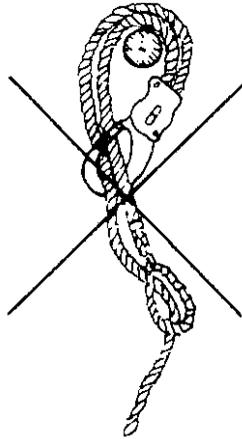
**Bild 27:** Falsches Anschlagen eines Seiles mit Falldämpfer
