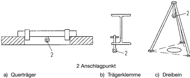
**Bild 21:** Beispiele für transportable, vorübergehend angebrachte Anschlageinrichtung
