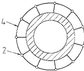
b) Anschlagseinrichtung, z.B. an einem Schornstein
