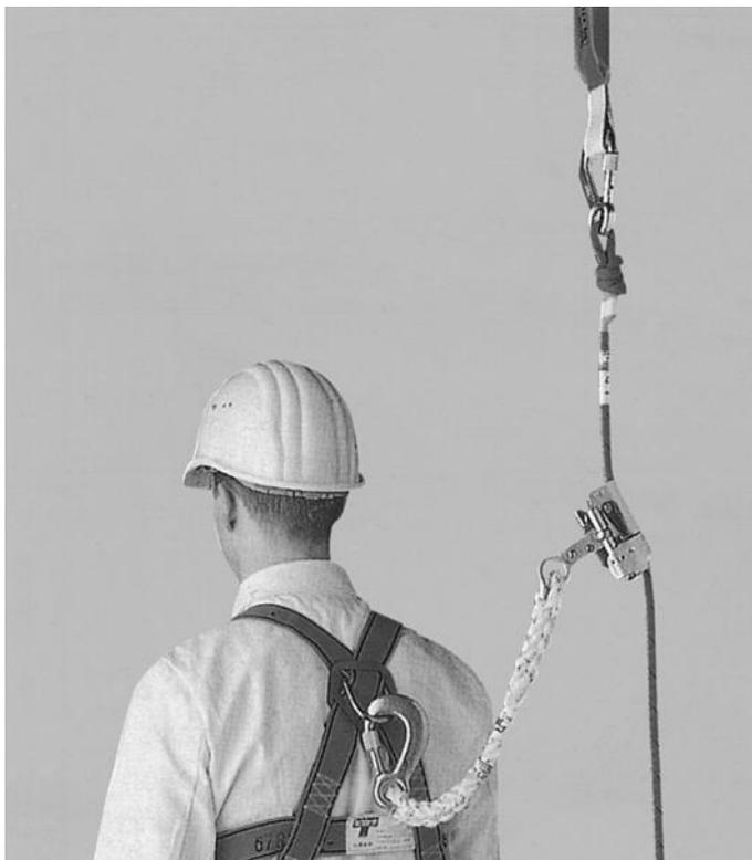
**Bild 2:** Beispiel des Auffangsystems:
