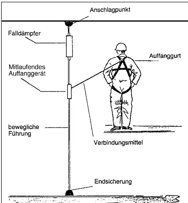
**Bild 1:** Systematische Darstellung des Auffangsystems: Mitlaufendes Auffanggerät einschließlich beweglicher Führung; in diesem Beispiel wird als Energie absorbierendes Einzelteil ein Falldämpfer verwendet
