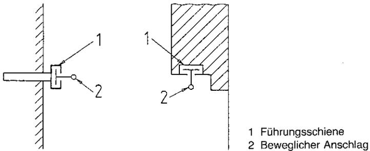
**Bild 24:** Beispiele für Anschlageinrichtungen mit horizontalen starren Führungsschienen
