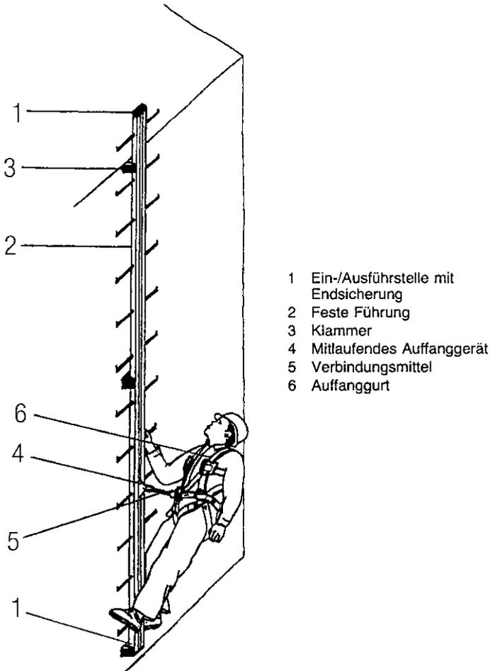
**Bild 3:** Skizze des Auffangsystems mit mitlaufendem Auffängerät einschließlich fester Führung (Steigschutzeinrichtung)
