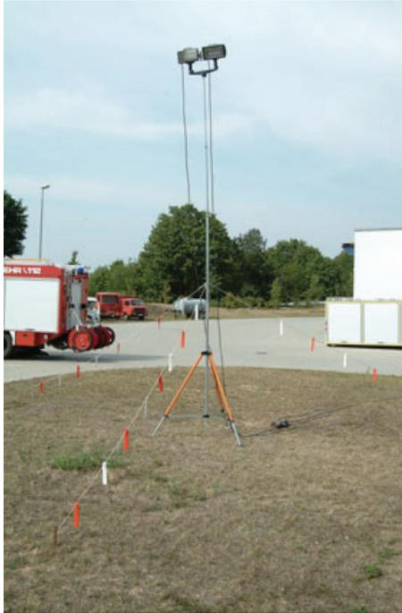
Die Anschlussleitungen der Flutlichtstrahler werden mit den Abgängen des Abzweigstückes verbunden und das Abzweigstück an die elektrische Leitung zum Stromerzeuger beziehungsweise an die Steckdose des Leitungsrollers angeschlossen.
