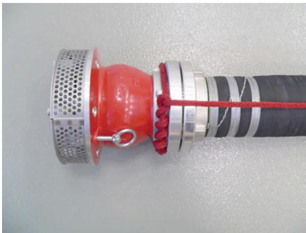
Sofern eine Halteleine verwendet wird, ist diese am Saugkorb vor dem Anbringen des Saugschutzkorbes mittels Zimmermannsschlag oder Mastwurf und Spierenstich zu befestigen. Anschließend wird sie an jedem Saugschlauch mittels Halbschlag befestigt. Es ist darauf zu achten, dass die Halteleine angemessen fest verlegt wird. Sie wird an einem geeigneten Festpunkt befestigt. Das Anbringen der Halteleine ist insbesondere bei fließenden Gewässern und in Schächten zweckmäßig.
