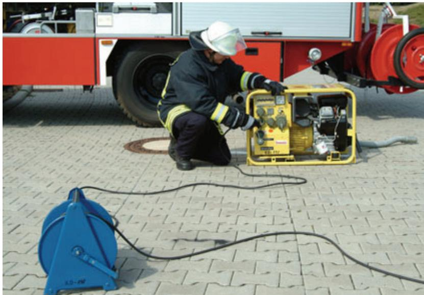
Der Maschinist nimmt den Stromerzeuger in Betrieb, zieht die Zuleitung mit Stecker von der Hilfstrommel ab und schließt, nachdem der Verbraucher angeschlossen und die gesamte elektrische Leitung (Stromversorgung) aufgebaut ist, den Stecker an den Stromerzeuger an.
