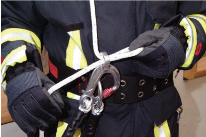
Die am Anschlagpunkt befestigte Feuerwehrleine wird in eine Schlaufe gelegt und durch die Multifunktionsöse des Karabinerhakens geführt. Die Schlaufe wird in den Karabinerhaken eingeklinkt.
