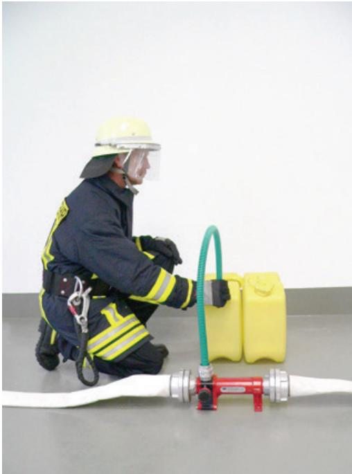
Der Zumischer wird in Richtung des Pfeils auf dem Zumischer zwischen Verteiler und Schaumstrahlrohr in die Druckschlauchleitung eingekuppelt.
