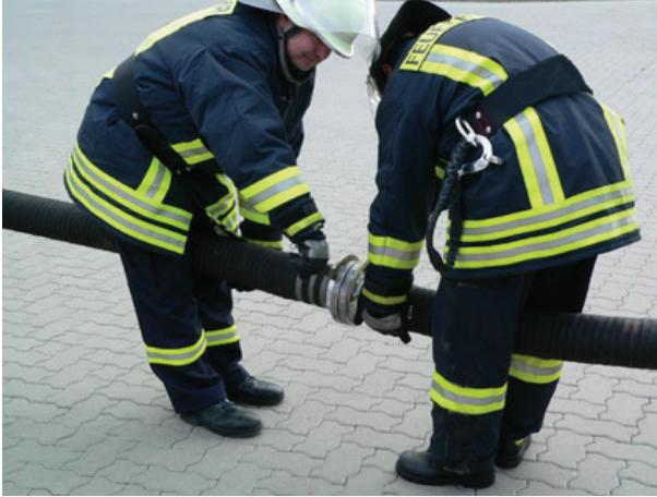
Die Saugschläuche werden beim Kuppeln zwischen den Beinen festgehalten. Die Kupplungen werden von Hand vorgekuppelt. Durch Rechtsdrehen fassen die Knaggen und werden mit dem Kupplungsschlüssel nachgezogen.
