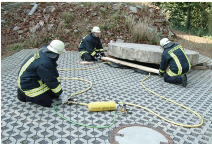
Zur Vergrößerung der wirksamen Auflagefläche und zum Erzeugen einer besseren Standsicherheit während des Hebevorgangs sollten zwei Druckkissen nebeneinander verwendet werden.
