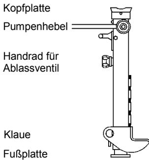
Zubehör der hydraulischen Winde
