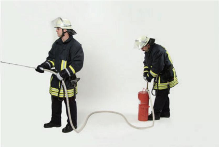
Die Kübelspritze A wird von zwei Feuerwehrangehörigen eingesetzt.
