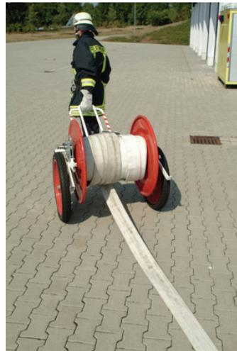
Die Schlauchhaspel wird an den Handgriffen gezogen. Der Schlauch muss von unten abrollen.
